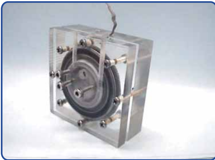
手作りで完成した小型燃料電池 (工学院大学)
